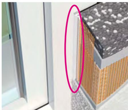
Gemäss den geltenden Standards ist der schlagregensichere Fenster- bzw. Türanschluss mittels go-Anputzleisten und/oder goFugendichtband zu fertigen. Bei Verwendung der Anputzleisten ist zunächst das Gewebe der Anputzleisten an den Laibunginnenseiten in den Unterputz einzubetten.
